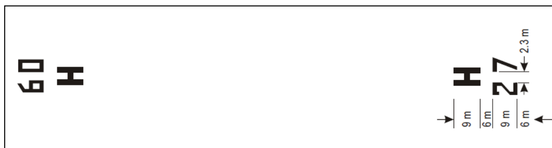
Rysunek 5-2. Oznakowanie tożsamości FATO oraz oznakowanie identyfikacyjne lotniska dla śmigłowców dla FATO typu droga startowa
