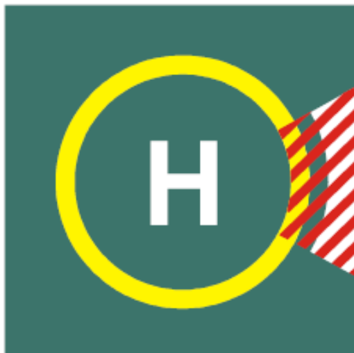
Rysunek 5-7. Oznakowanie sektora, którym nie wolno lądować na lotnisku dla śmigłowców na platformie
